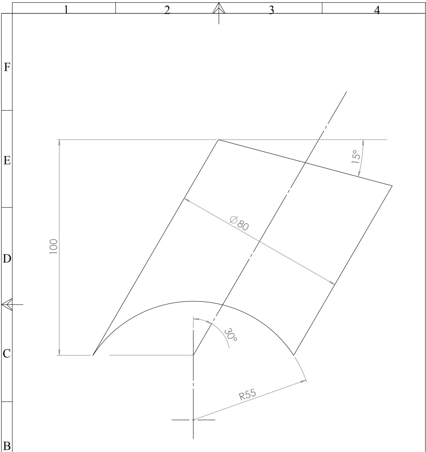
Sur un format A3 Tracer l'épure nécessaire au développement.
