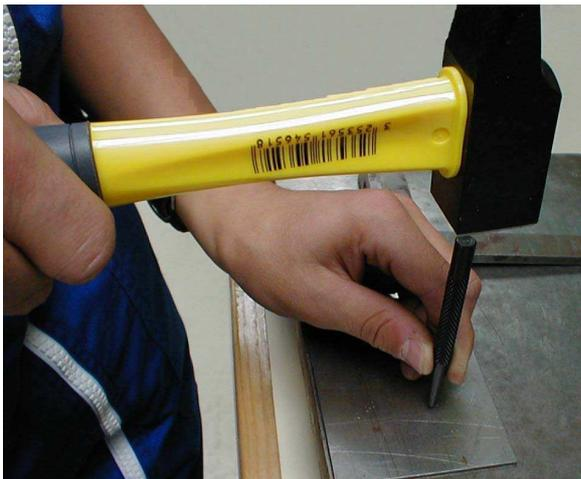
Il se réalise à l'aide d'un \_\_\_\_\_ et d'un \_\_\_\_\_ . On pose le pointeau à la \_\_\_\_\_ sur l'endroit à pointer (cet endroit est déterminé par \_\_\_\_\_ de 2 traits de traçage) et on \_\_\_\_\_
