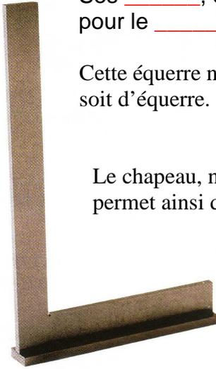
Cette équerre nous permet de tracer des droites à \_\_\_\_\_, à condition que la tôle soit d'équerre.
